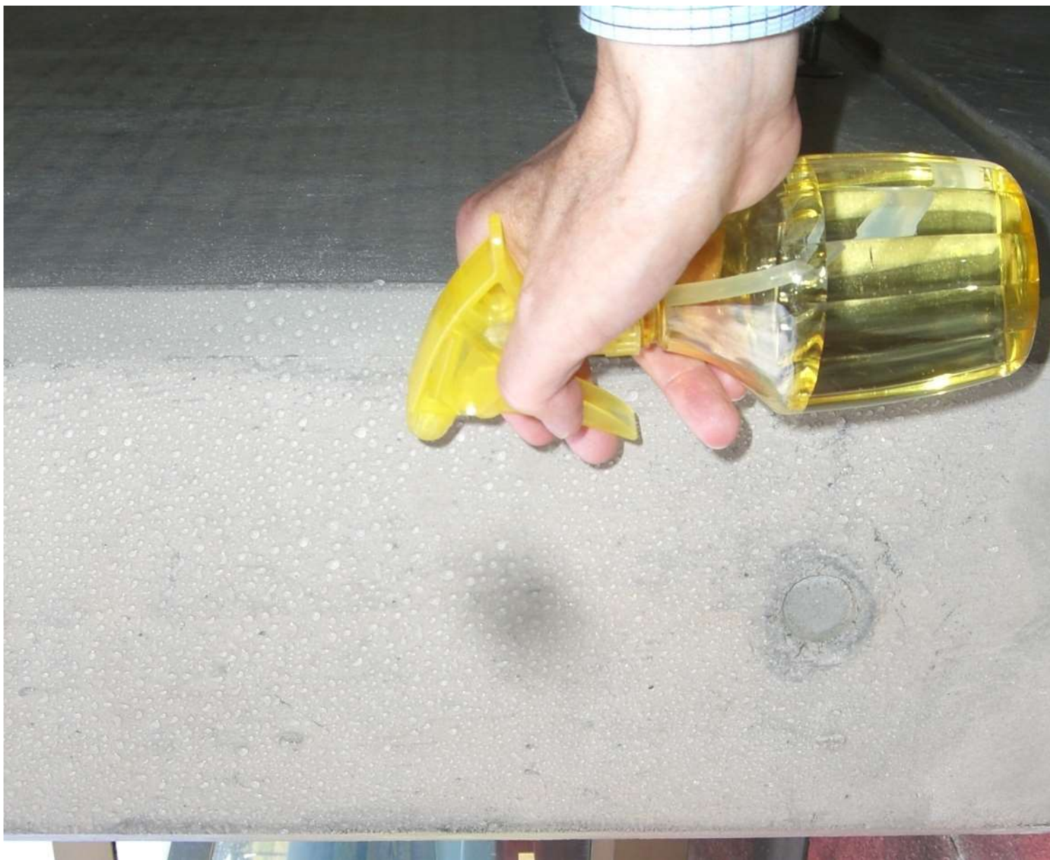
ランデックスコート WS疎水剤 表面撥水状態及び耐久性
